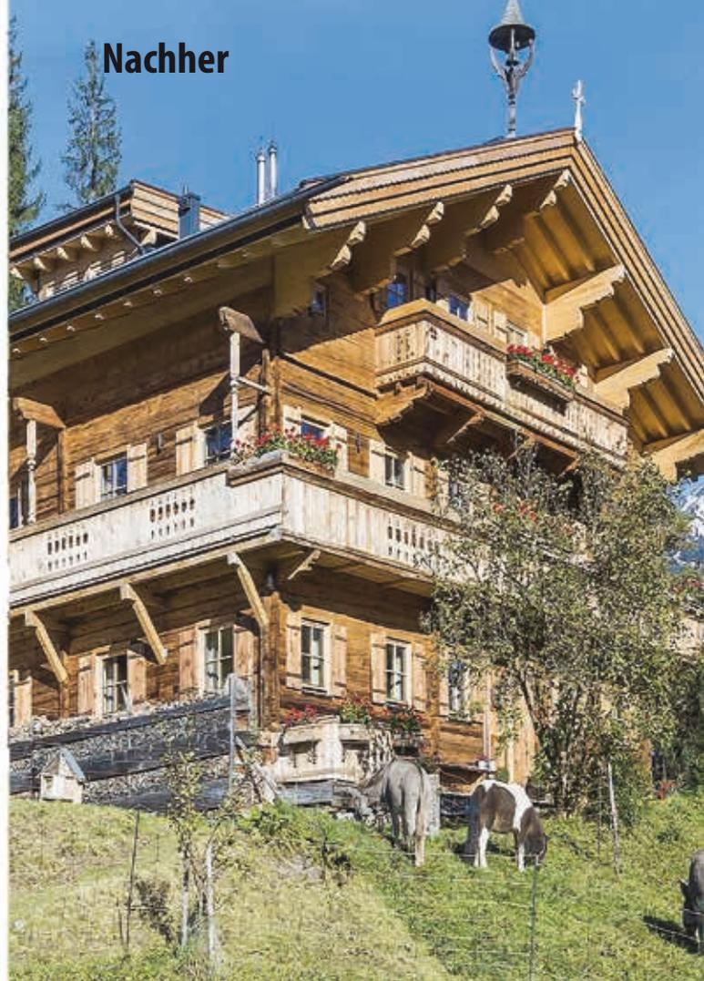
Biobauernhof „Wald am See“ in Kitzbühel - [www.waldamsee.at](http://www.waldamsee.at) / Nach dem Sandstrahlen und Erneuerung einzelner Teile kompletter Oberflächen-Neuaufbau mit Complex Oberfläche: Complex Hydrolan Holzöl
